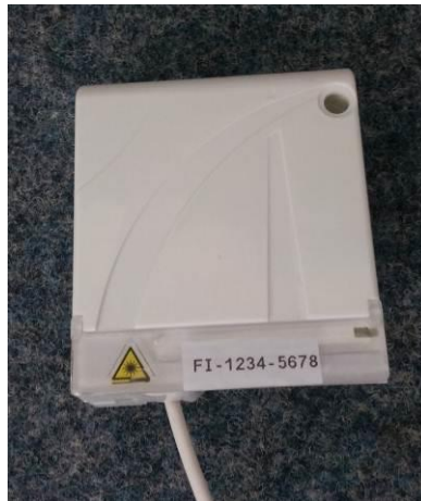
Figure 4 : repérage sur la prise mono fibre
