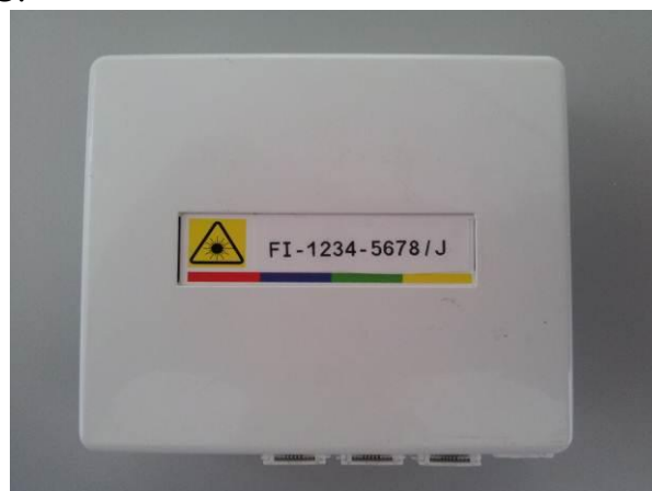
Figure 5 : repérage sur la prise quadri fibre
