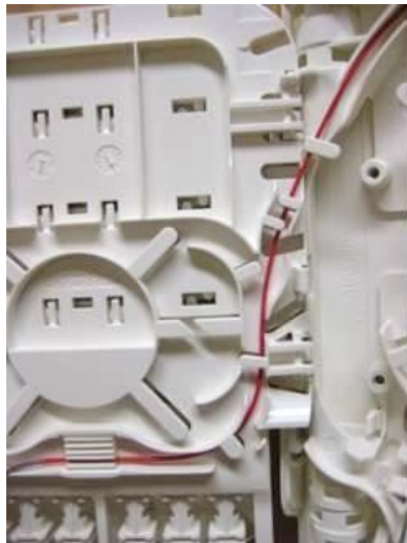
Figure 10 : Arrivée du \mu module à l'arrière de la platine-cassettes
