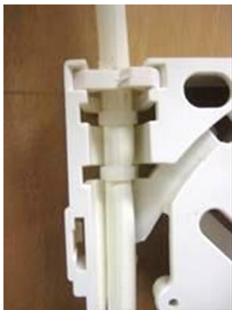
Figure 7: Détail sur l'étanchéité de l'entrée de câble
