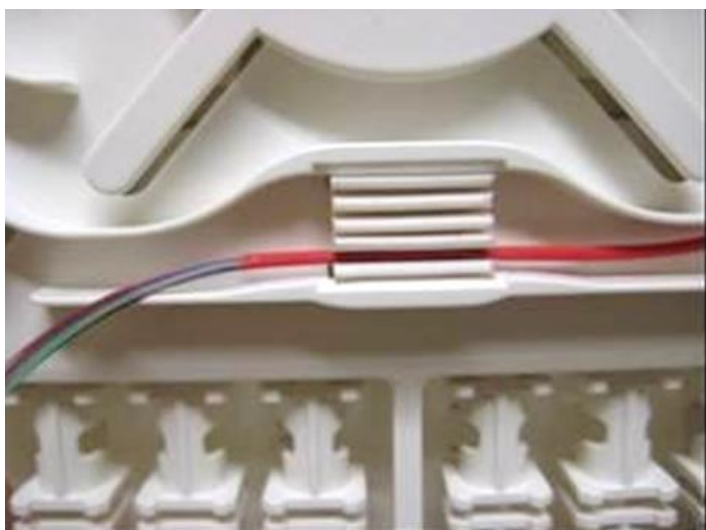
Figure 11 : Blocage du \mu module dans le peigne de la zone de stockage
