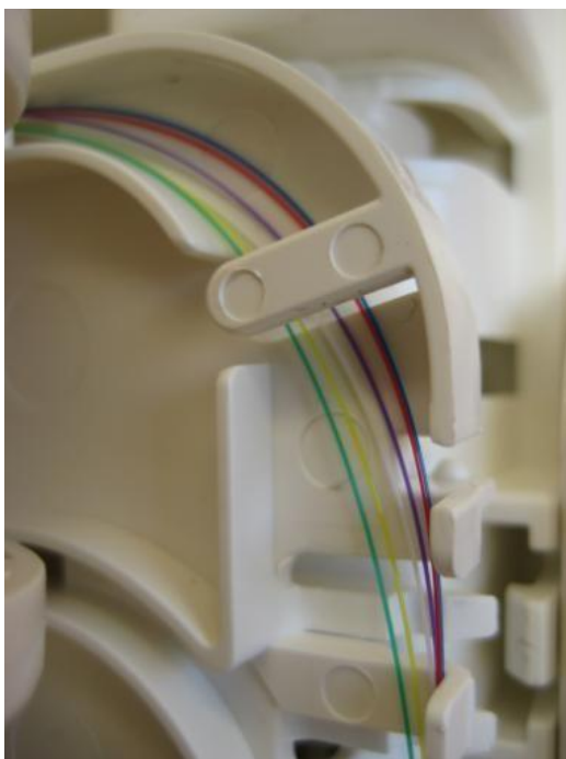
Figure 15 : Arrivée des fibres au niveau de la cassette
