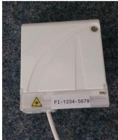
Figure 4 : repérage sur la prise mono fibre
