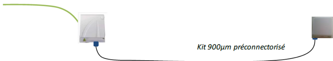
Figure 7 : exemple de câblage avec PTO déportée
