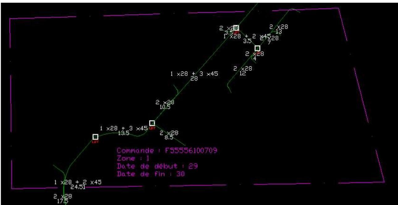
Pour faciliter la lecture, les réservations d'Alvéoles devront apparaître directement au niveau du calque de commande qui se superpose avec le Plan itinéraire géo-référence grâce à une annotation aux abords de la Chambre.
