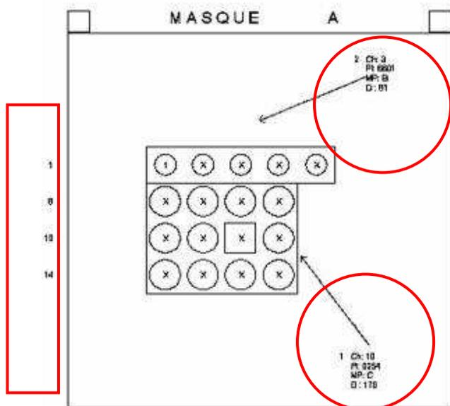
En plus de cette représentation du Masque physique, l'Opérateur doit obligatoirement distinguer les différents Masques logiques (deux dans l'exemple ci-dessus). Chacun de ces Masques regroupe les Alvéoles en direction d'une autre Chambre. Le numéro de la Chambre de destination est également précisé. Ici les Alvéoles 8 à 17 du Masque A vont en direction de la Chambre 10 (Masque logique 1) alors que les Alvéoles 1 à 5 de ce même Masque vont vers la Chambre 3 (Masque logique 2).
