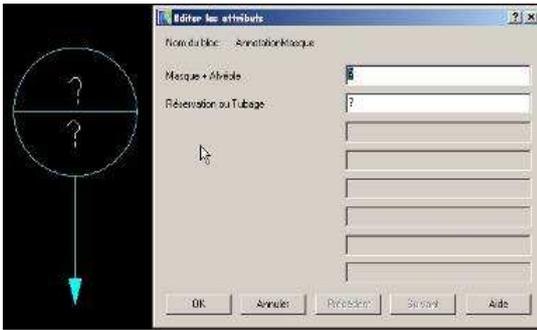
la lettre T pour tubage accompagnée de t pour tube ou s pour tube souple (Tt,Ts) , indiquer le nombre et diamètre des tubes
