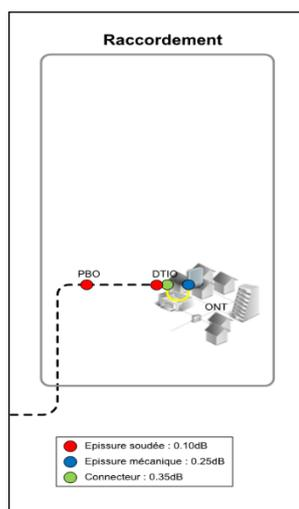
Pour rappel du fonctionnement : lors du raccordement de l'abonné, la fibre de branchement est soudée à la fibre de distribution.
